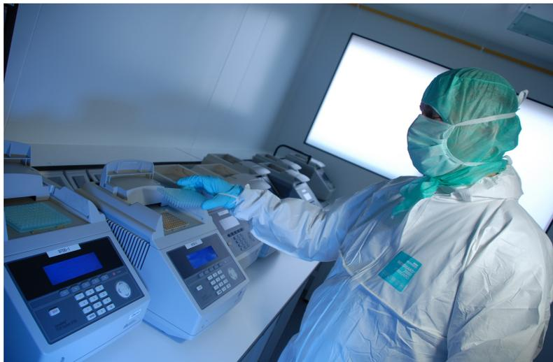
*Appareil à PCR : analyse des plaques de 96 puits contenant de l'ADN © IRCGN*
